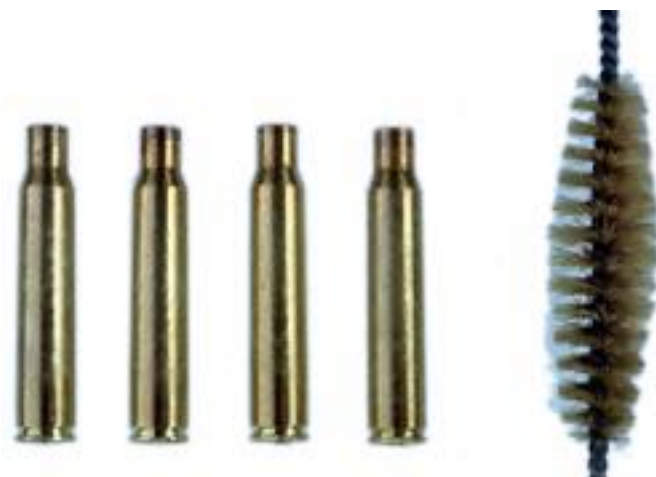
Photo n° 1 - Douilles déformées par l'oxydation de la chambre et restées coincées dans la chambre. Ecouvillon de chambre
