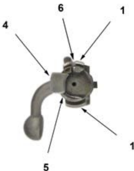
Photo n°4 : Tête de culasse de type "Mauser 98"
