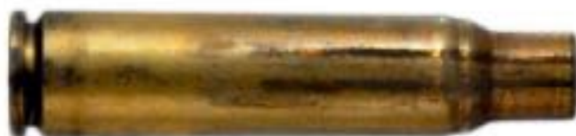
Photo n° 2 : Douille marquée par le retour de gaz par les cannelures fraisées dans la chambre
