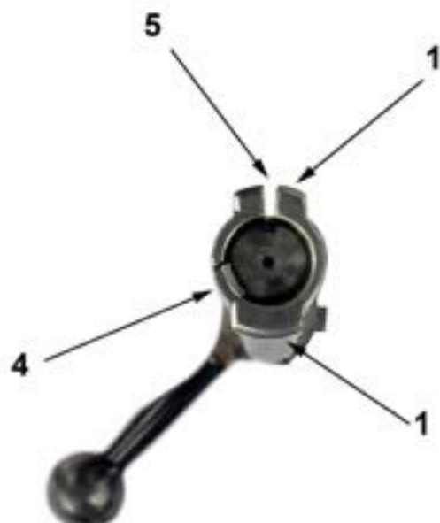
Photo n°5 : Tête de culasse du type "Remington 700"
