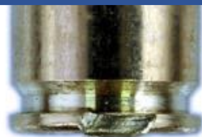
Photo n° 3 : Bourrelet d'une douille de 7x64 arrachée par un extracteur
