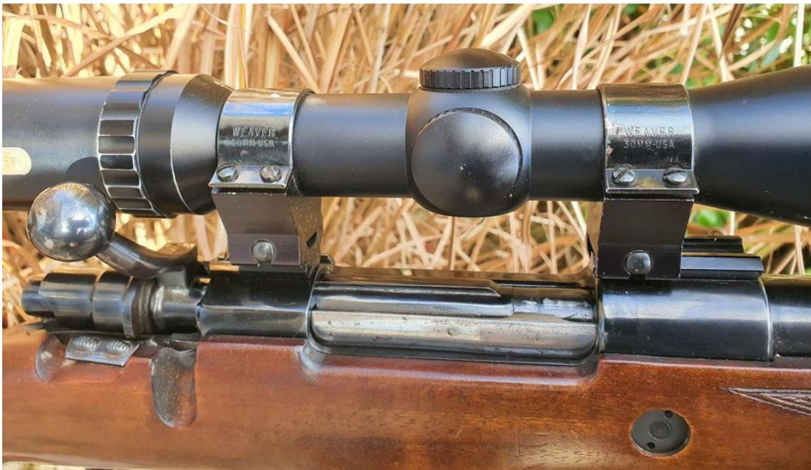
Un des montages les plus classiques qu'il soit : 2 embases fixées sur 2 rails, eux-mêmes fixés sur le boîtier de culasse taraudé.
