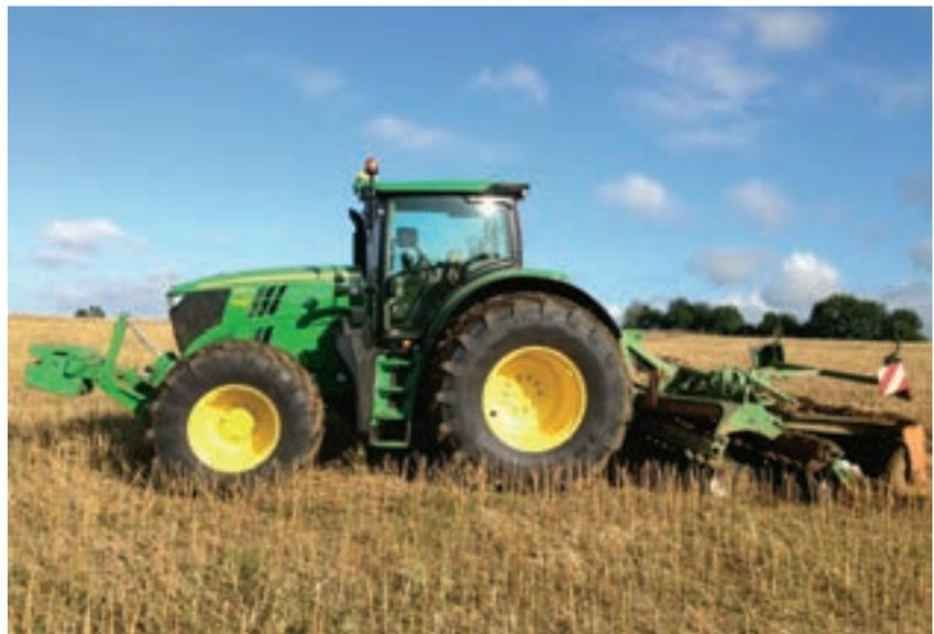
*Outil à disques permettant un bon mélange paille-terre sur une faible profondeur*
