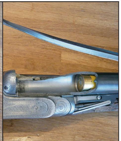
*Une cartouche de calibre 20 dans un calibre 12 avec éclatement de la chambre.*
